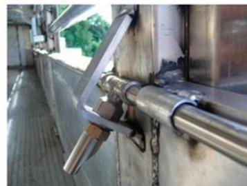
**Fotografías 10:** Instalación de duchas con conductos de inoxidable accionadas con mando a distancia e instalación de 2 chupetes para beber en cada departamento, con conductos de inoxidables, en carrocería de aluminio para transporte de cerdos en la UE. Extraída de los archivos del curso de posgrado en comportamiento animal de la maestría en Sistemas Productivos en Regiones Semiáridas de la FA de la UNLPam (2013).
